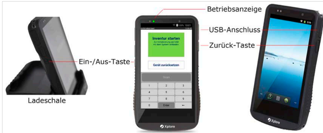
Basisstation, Bedientasten und USB-Anschluss des Inventurgeräts Xplore DT4100
