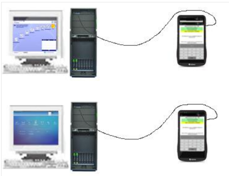
USB-Anschluss zur Geräteinitialisierung an XT- und IXOS-Geräten
